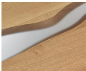
Harz ist im Ursprungszustand farblos und wird durch einen Zusatz farblich intensiviert. Es lässt sich weder durch Wärme (bis 200 Grad) noch durch andere Einflüsse verformen und ist lebensmittelrechtlich.
