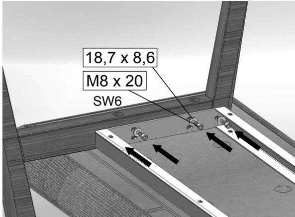
3. Die Holzbügel **zunächst lose** mit dem Rahmen verschrauben.
