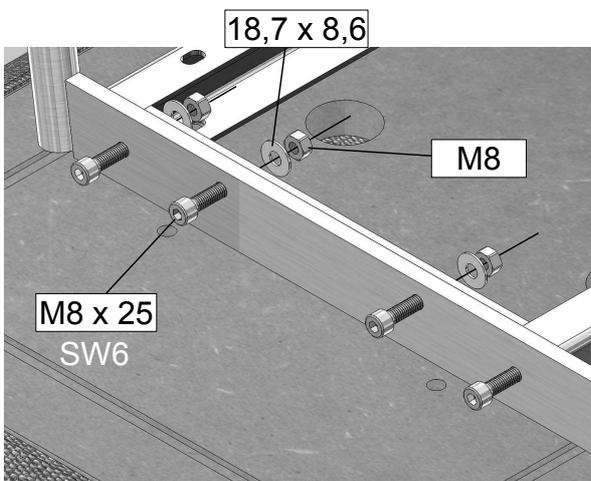
3. Die Metallbügel mit den Bohrungen mittig zu den Langlöchern des Verstärkungsrahmens ansetzen.
