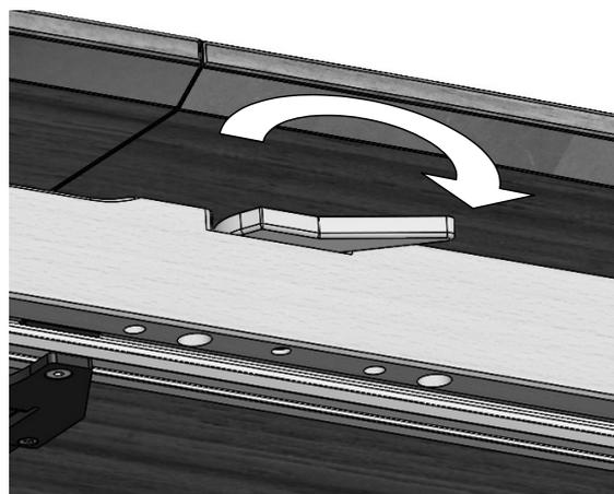
5. Vor dem Ausziehen auf beiden Seiten die schwarzen Bremshebel lösen.
