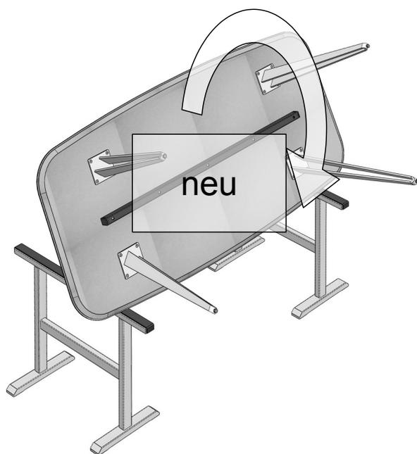
4. Den Tisch wenden, ohne die FüÙe zu belasten und dann gleichzeitig alle 4 Tischbeine auf dem Boden absetzen.
