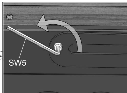
7c. Auf beiden Seiten die beiden Klemmschrauben etwas lösen.
