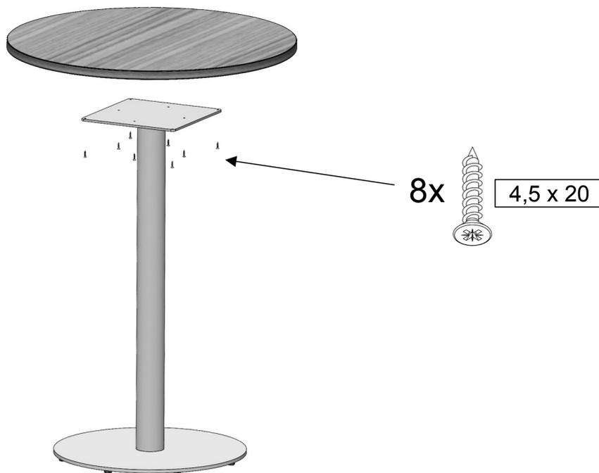
4. Das vormontierte Untergestell wenden und mit der Platte verschrauben.
