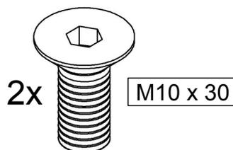
3. Die Bodenplatte mit der Tischsäule verschrauben.
