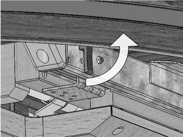
9. Vor dem Ausziehen auf beiden Seiten die schwarzen Bremshebel lösen.
