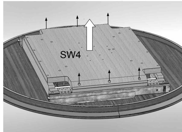
2. Den Oberbau umgedreht auf eine ebene Fläche ablegen und die Verpackung öffnen. Die Halteplatte abschrauben und die Inbusschrauben aufheben.
