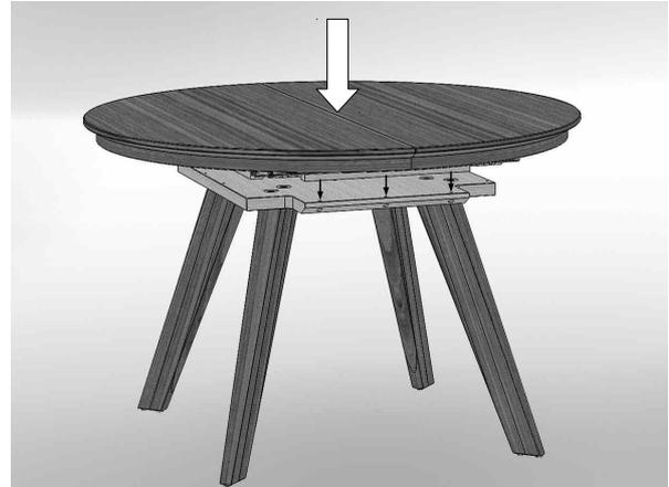
6. Den Oberbau auspacken und so auf dem Unterbau positionieren, dass die Bohrungen fluchten.
