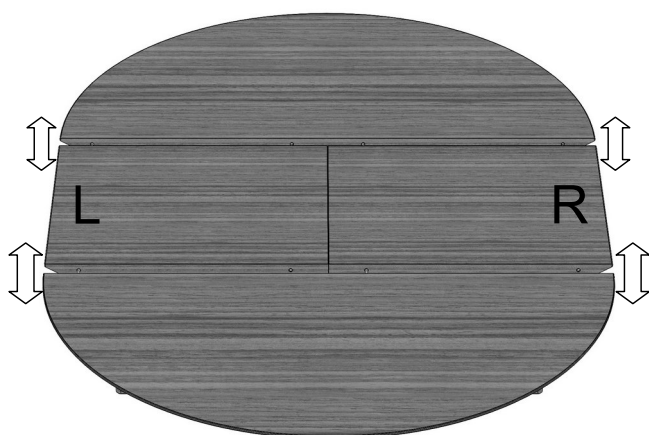
11. Prüfen, ob die Oberkanten des Auszugs und die Hauptplatten außen auf einer Höhe sind. Nur wenn nicht ...
