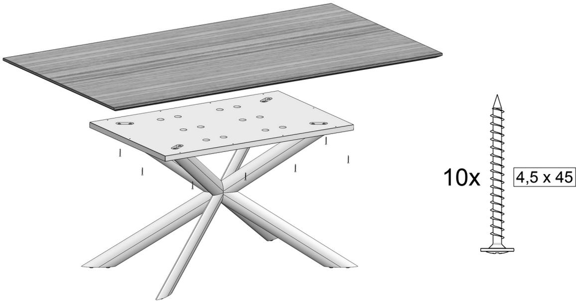
3. Den Oberbau auf die Trägerplatte legen und verschrauben. Die vorhandenen 4 Bohrungen zur Positionierung wieder verwenden.
