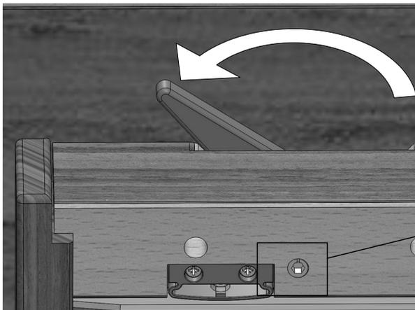
7. Vor dem Ausziehen auf beiden Seiten die schwarzen Bremshebel lösen.
