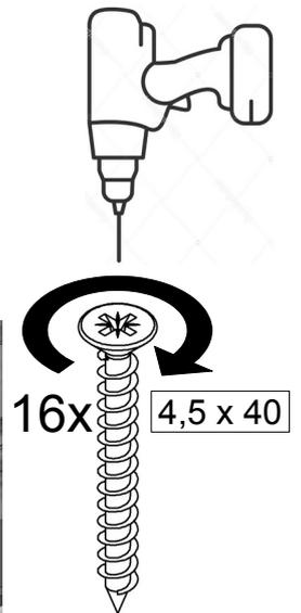
4. Die beiden Stahl-Platten des vormontierten Unterbaus nun wieder an den Oberbau schrauben.
