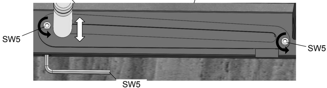
10. ... die beiden äußeren Inbusschrauben etwas lösen. Nun durch Drehen der inneren Inbusschraube die Höhe der Drehstange einstellen. Anschließend die beiden Inbusschrauben wieder festziehen.
