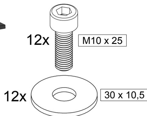
3. Die beiden Unterbauten an den oben angegebenen Positionen mit der Trägerplatte verschrauben.
