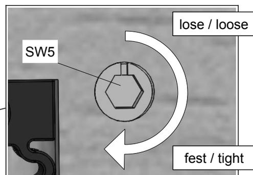
8. Kerbe nach außen: geringe Vorspannung
