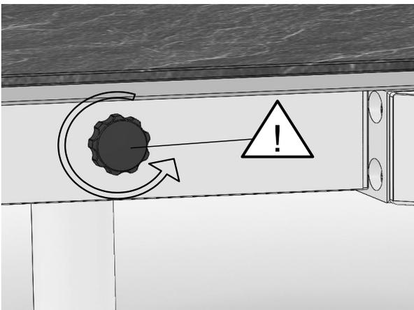
11. Vor dem Ausziehen auf beiden Seiten die schwarzen Bremsschrauben lösen.
