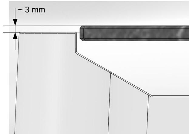
10. Prüfen, ob die Hauptplatte gegenüber den Tischbeinen etwa 3 mm höher ist. Die Tischbeine können nach dem Lösen der Schrauben (s.a. P. 5 + 8) vertikal etwas verschoben werden. Anschließend die Schrauben wieder festziehen.
