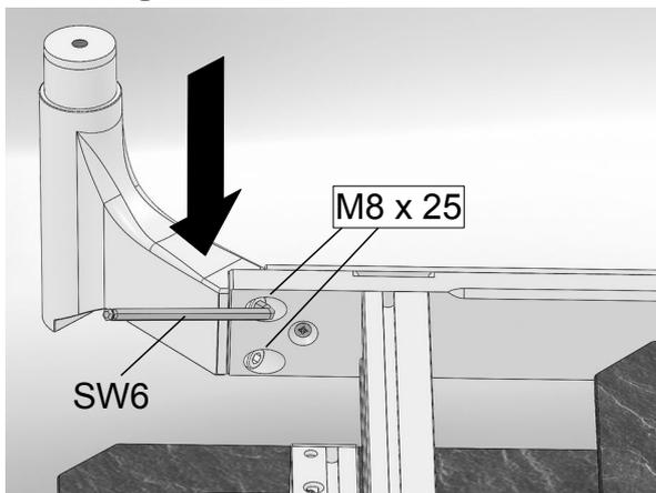
3. Die beiden Tischbeine mit je zwei Schrauben und dem mitgelieferten Inbusschüssel befestigen. Die beiden Tischbeine beim Anschrauben **nach unten drücken**.
