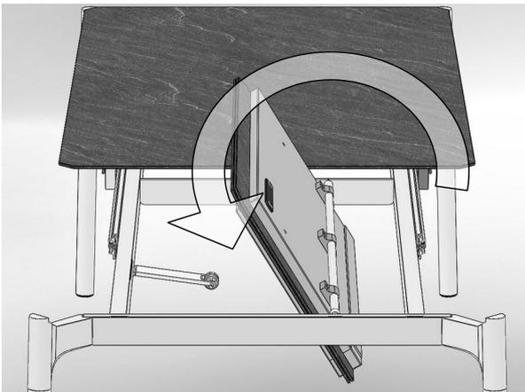
13c. **Beide** Halpteile **gleichzeitig** zurückklappen.
