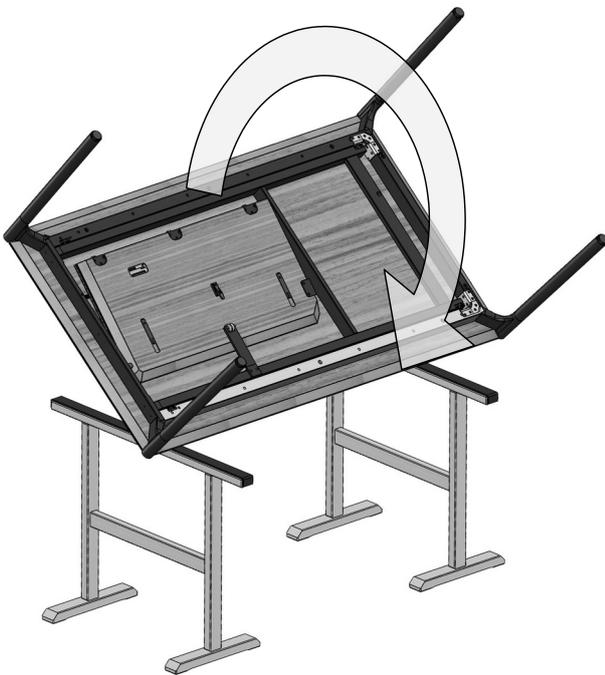
5. Den Tisch wenden, ohne die FüÙe zu belasten und dann gleichzeitig alle 4 Tischbeine auf dem Boden absetzen.
