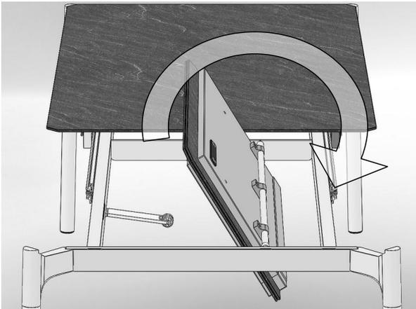
17a. Die Klappenlage fassen und **beide Teile gleichzeitig** vorsichtig hochklappen...
