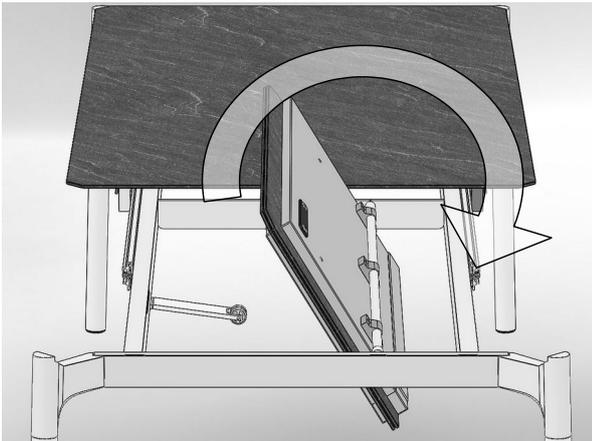
13a. Die Klappenlage fassen und **beide Teile** gleichzeitig vorsichtig hochklappen...
