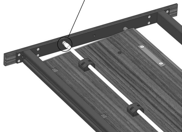
11. Wenn nötig, auch die gegenüberliegende Lagerung der Drehstange justieren. Dazu ggf. die Hülse nach hinten ziehen und dann mit einem Mausschlüssel die Mutter (SW13) etwas lösen. Nun durch Drehen der in der Traverse befindlichen Inbusschraube (SW2,5) die Höhe der Drehstange einstellen. Anschließend die Mutter der Drehstange wieder festziehen.
