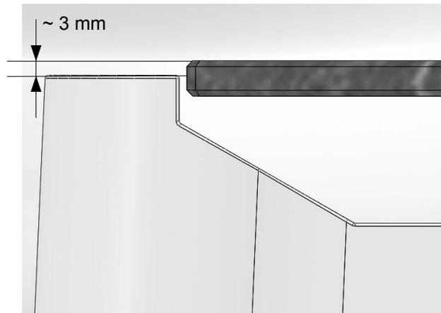
6. Prüfen, ob die Hauptplatte gegenüber den Tischbeinen etwa 3 mm höher ist. Die Tischbeine können nach dem Lösen der Schrauben (s.a. P. 3 + 4) vertikal etwas verschoben werden. Anschließend die Schrauben wieder festziehen.
