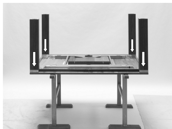
4. Die FüÙe auf die Gewindestangen aufstecken und die Dübel der FüÙe in die Metall-Halteplatten einstecken. Die Leimfugen der FüÙe sollen in Längsrichtung des Tisches ausgerichtet werden (s.a. Bild 5). 4. Insert the legs on the threaded bars and put the dowels of the legs into the holes in the metal holding plate. The glued joint should run along the long side of the table (see also pic. 5).
