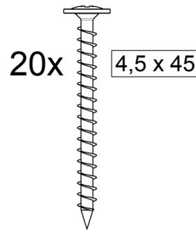
4. Die Sperrholz-Platte des vormontierten Unterbaus nun wieder an den Oberbau schrauben. Auch die zusätzlichen Spax-Schrauben eindrehen.
