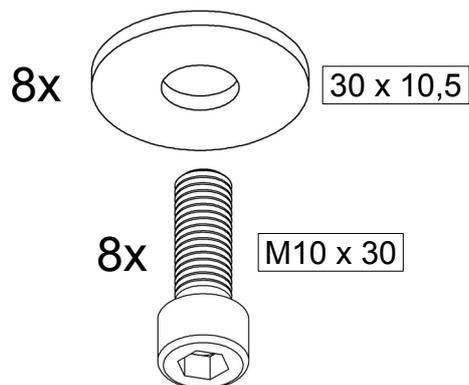
3. Die Bolzen der Tischbeine in die im Bild gezeigten Löcher stecken. Jeden Bolzen mit mit einer Unterlegscheibe und einer Mutter fixieren.
