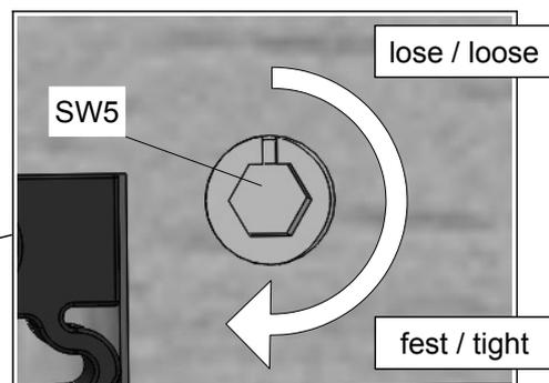
7. Kerbe nach außen: geringe Vorspannung
