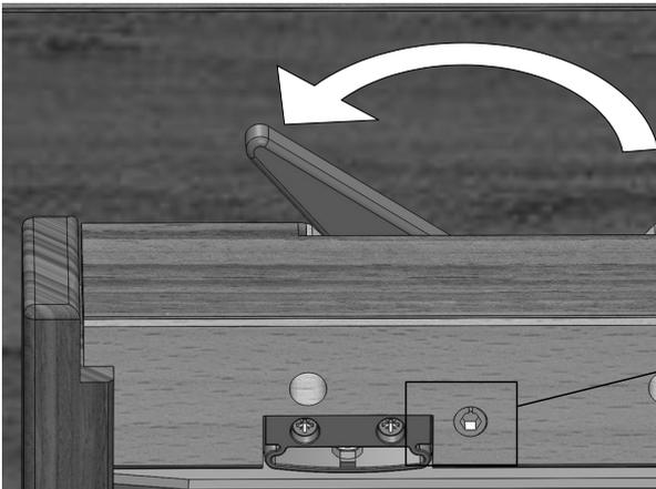
6. Vor dem Ausziehen auf beiden Seiten die schwarzen Bremshebel lösen.
