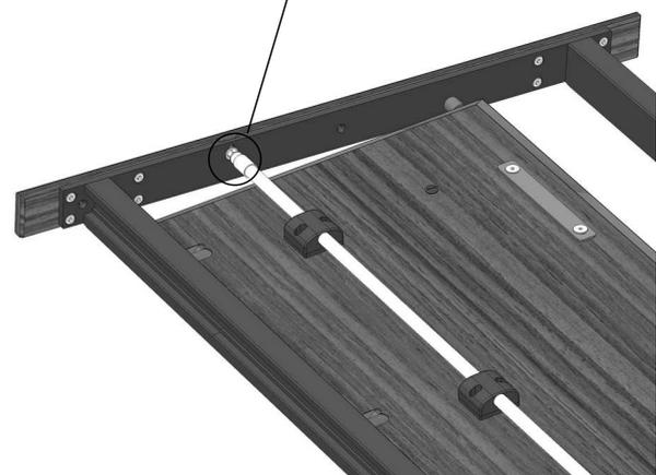
12. Wenn nötig, auch die gegenüberliegende Lagerung der Drehstange justieren. Dazu ggf. die Hülse nach hinten ziehen und dann mit einem Maulschlüssel die Mutter (SW13) etwas lösen. Nun durch Drehen der in der Traverse befindlichen Inbusschraube (SW2,5) die Höhe der Drehstange einstellen. Anschließend die Mutter der Drehstange wieder festziehen.
