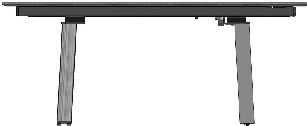
7. Fertiger Tisch in der Seitenansicht. Die beiden Unterbauten sind etwas nach außen abgewinkelt. 7. Finished table. Both base frames are slightly angled outside.
