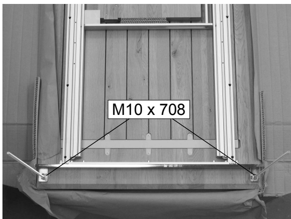
3. Auf beiden Seiten je zwei Gewindestangen eindrehen. 3. Turn in 2 threaded bolts into each side of the table-top.
