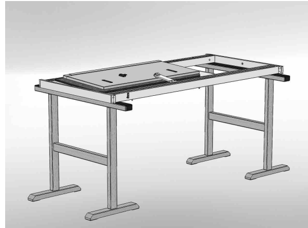
2. Den Oberbau umgedreht auf gepolsterten Montageböcken ablegen. 2. Put the table-top upside down onto padded assembling trestles.
