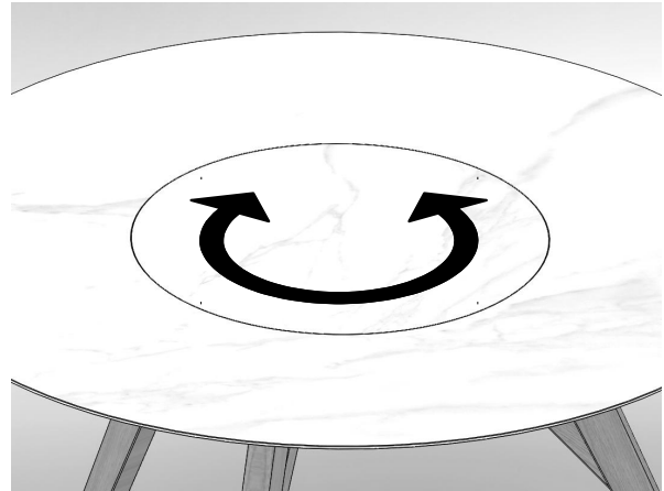
8. Prüfen, ob der Drehteller frei läuft und sich im Zentrum der Platte befindet. Wenn nicht... 8. Check, if the rotary plate is freewheeling and if it is in the middle of the plate. If not...
