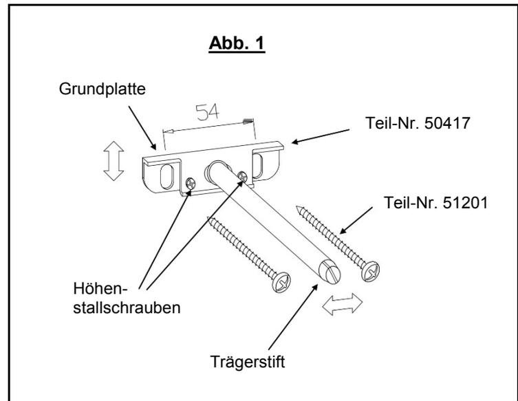
**1.** Bohrmaße für Tablarträger laut Übersicht an Zimmerwand übertragen (Maßangaben bezogen auf Mitte Beschlag). Pro Beschlag 2 x Ø8 mm Löcher in Abstand 54 mm in das Mauerwerk bohren und Dübel Ø8 x 40 mm (Teil-Nr. 50801) einsetzen.
