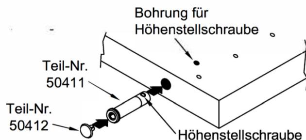
Höhenversteller (Teil-Nr. 50411) an der Stollenunterseite einsetzen. Höhenstellschraube muss mit seitlicher Bohrung am Stollen übereinstimmen. Gleitstopfen (Teil-Nr. 50412) aufstecken
