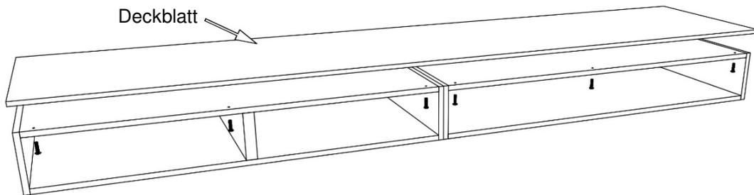
**12.** Frontteile wieder einbauen und ggf. ausrichten.
