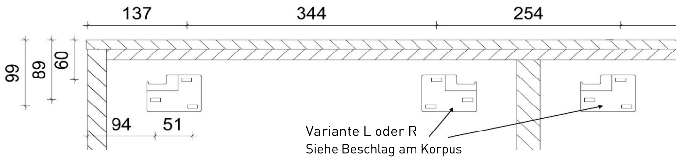
Abbildung 2: Verstellung &amp; Aushängesicherung Hängebeschlag
