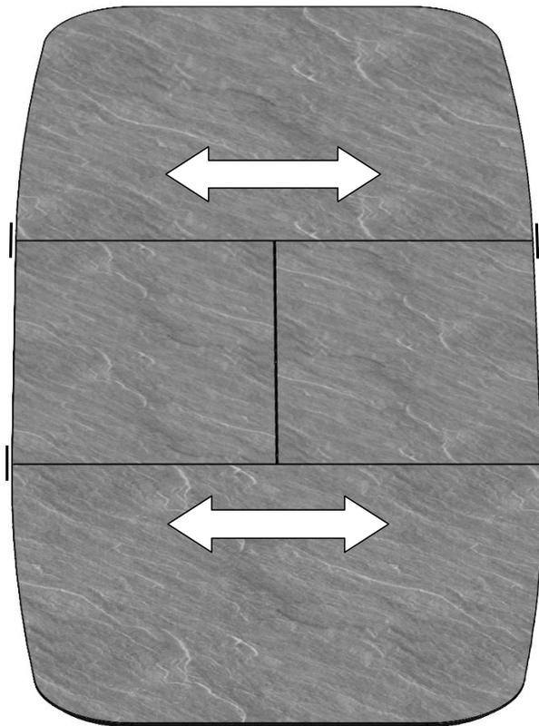
8b. Die beiden Hauptplatten Halpteile zur Klappeinlage bündig ausrichten und danach die Verbindungsschrauben anziehen.
