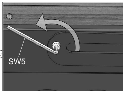
11c. Auf beiden Seiten die beiden Klemmschrauben etwas lösen.
