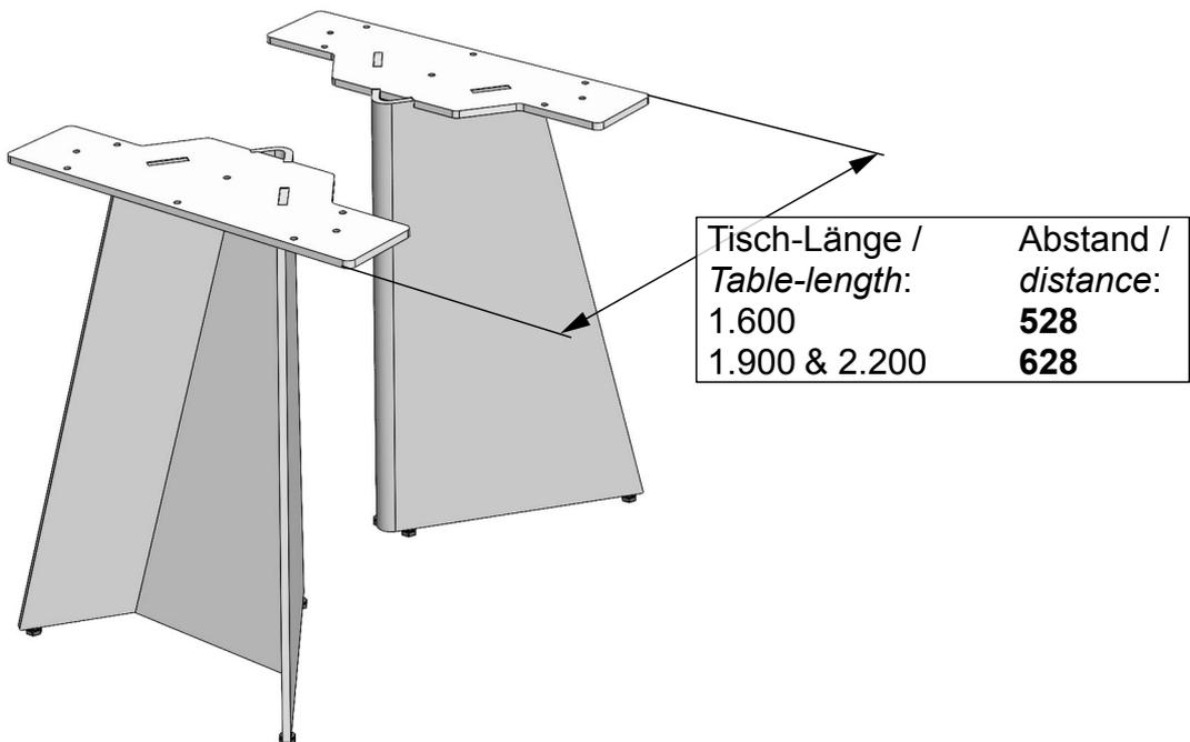
2. Die Unterbauten am Verwendungsort des Tisches mit der angegebenen Außendistanz aufstellen.
