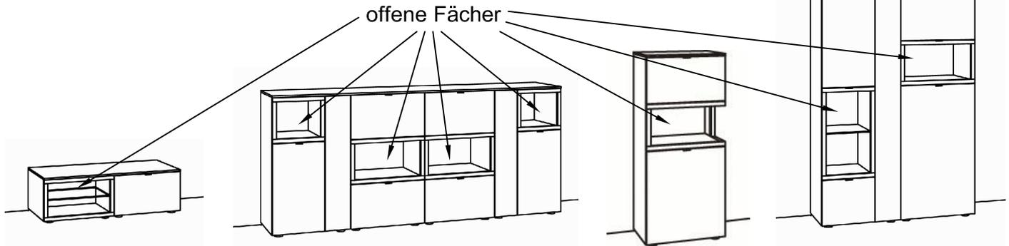
Offene Fächer sind als komplette Einsätze in einem Artikel eingebaut. Sie sind mit dem unterhalb befindlichen Korpusboden bzw. der nebenstehenden Seite des Möbels verschraubt, Eckfächer haben eine Befestigung mit der Rückwand. Bei einem Ausbau des offenen Fachs Schrauben lösen und den Einsatz aus dem Korpus ziehen. Bei Artikeln mit Beleuchtung (Zubehör) ist auf das Anschlusskabel auf der Rückseite des Möbels zu achten!
