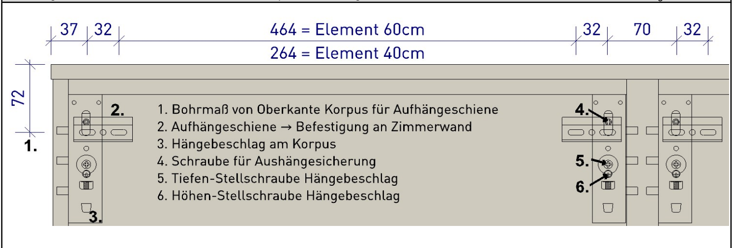
Abbildung 1: Bohrmaße (in mm) von Außenkante Korpus für Aufhängeschienen
