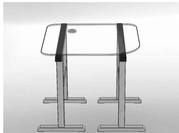
2. Die Glasplatte auspacken und auf gepolsterten Montageböcken ablegen. 2. Unpack the glass. Lay the glass onto padded assembling trestles.
