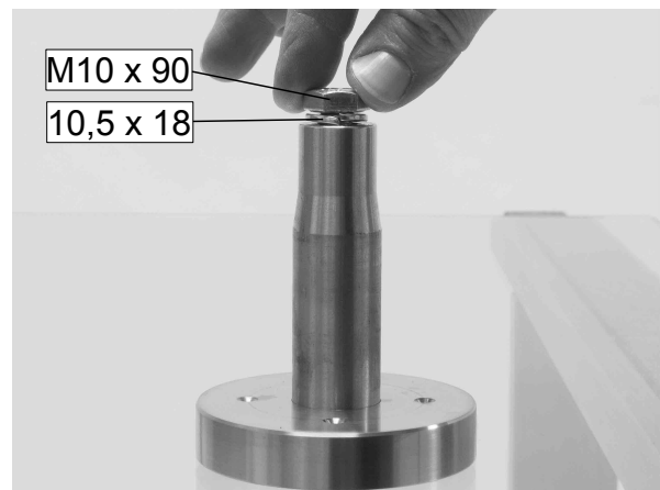
4. Den Sprengring auflegen und die Schraube eindrehen. 4. Put the snap-ring onto the bolt and turn in the screw.
