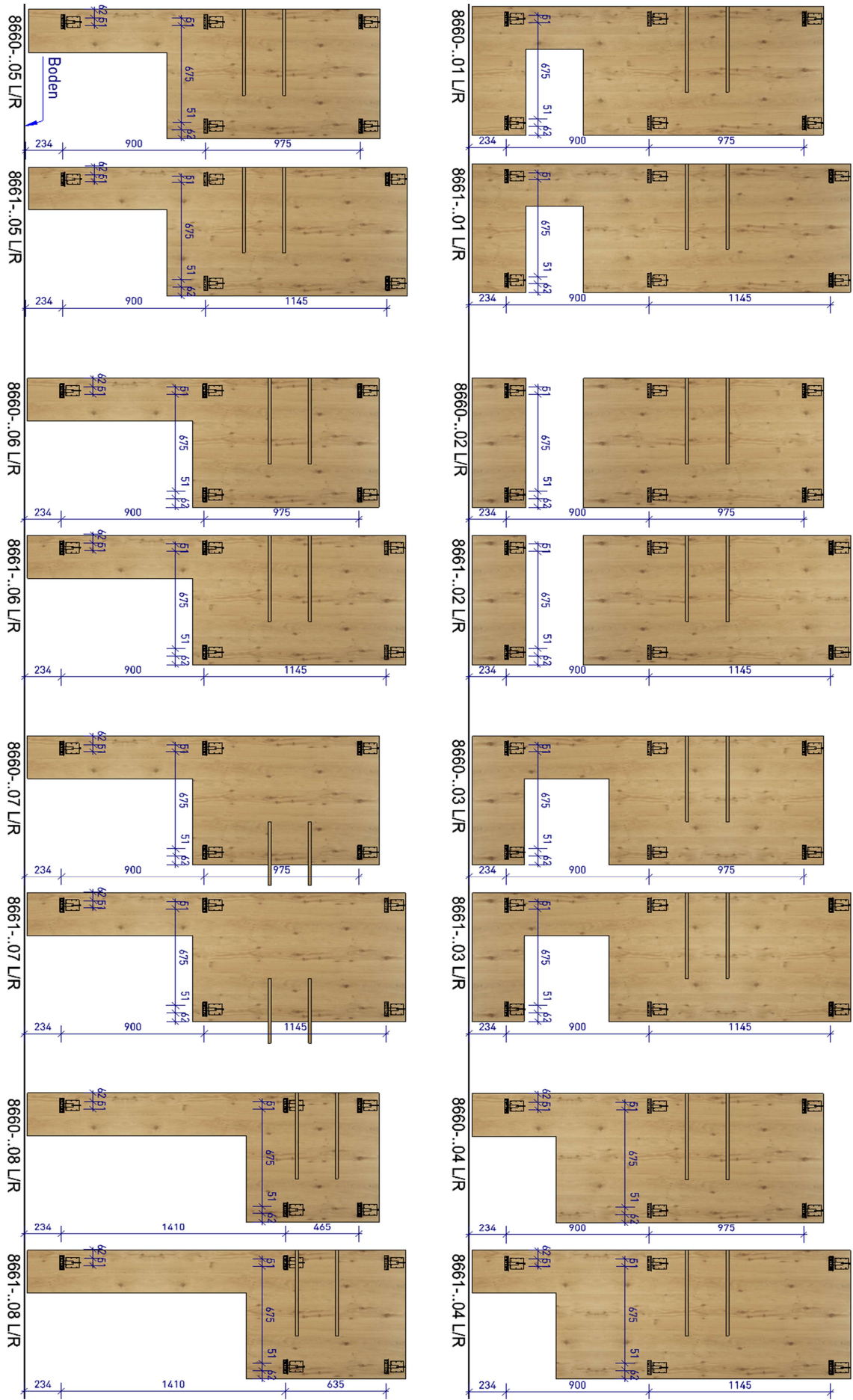
Abbildung 4: Bohrmaße (in mm) von Außenkante Paneel / Fußboden für Aufhängeschienen
